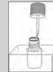
Kunststoffrohr. Der Einsatz sorgt dafür, dass überschüssige Flüssigkeit abgestreift wird.
